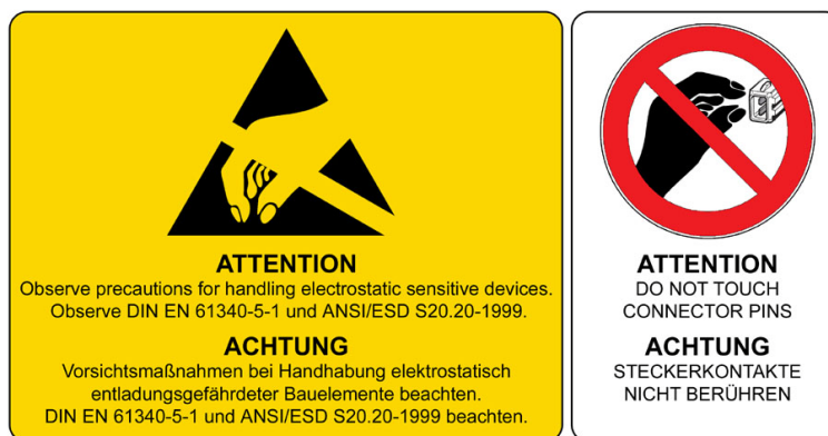
Aufkleber "elektrostatisch entladungsgefährdete Bauelemente" / Sticker "electrostatic sensitive devices"
